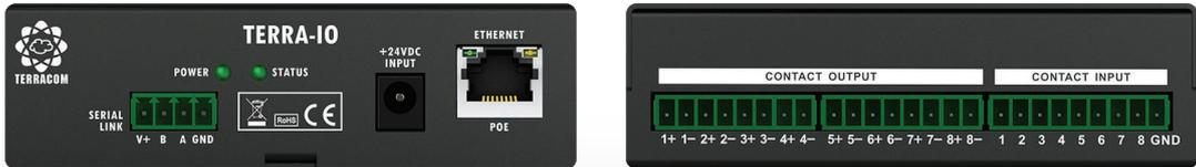
**TERRA-8IO Vox@** est un boîtier programmable doté de 8 entrées contact surveillées et de 8 sorties relais idéal pour les applications d'automatisation de sites industriels ou pour la surveillance des fermetures de contacts. Il convient également pour les applications nécessitant de nombreuses entrées/sorties.
